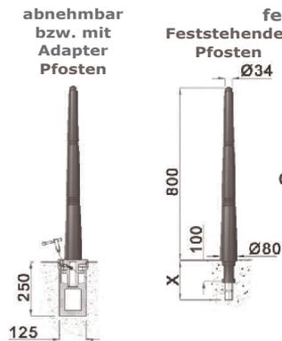
Metallisierter, lackierter Guss.
