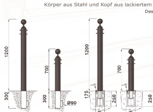
Körper aus Stahl und Kopf aus lackiertem Aluminium.
